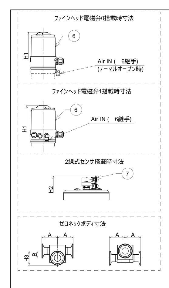
図はノーマルクローズを基準としています。 フェルールは ISOフェルール継手を使用しています。 ブリードポートの向きは、ネジ締結のため製品ごとに異なります。 参考重量は想定最大時の重量です。 アクチュエータとボディの取付は90°毎に回転可能です。
